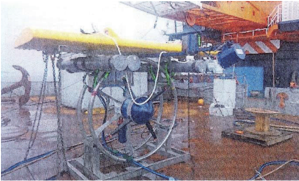
図 11 海流発電装置の実海域実験
